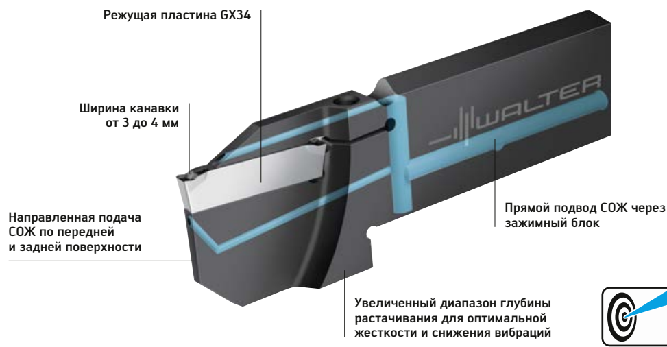
Державки с направленной подачей СОЖ. Режущие пластины GX34
