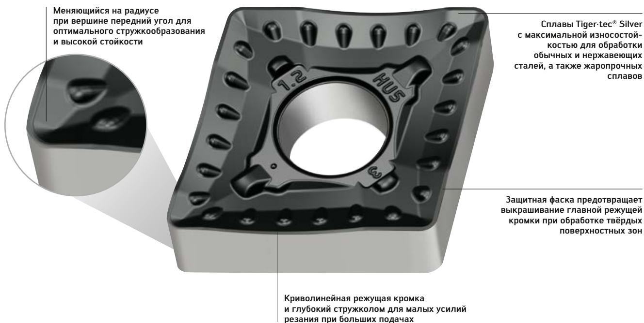
Односторонняя пластина для черновой обработки
