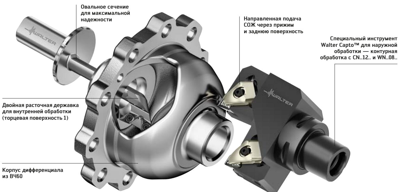
Двойная державка для наружной и внутренней обработки
